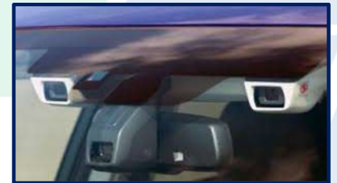
Imagen 7. Integración de cámaras para sistema de visión estereoscópica en vehículo en su luna frontal
